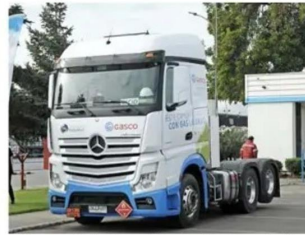
Primer camión de alto tonelaje que utiliza sistema dual fuel gas-diésel - de propiedad de Transportes Maquehua - que opera en el servicio de transporte de gas desde terminales hasta plantas de almacenamiento.
